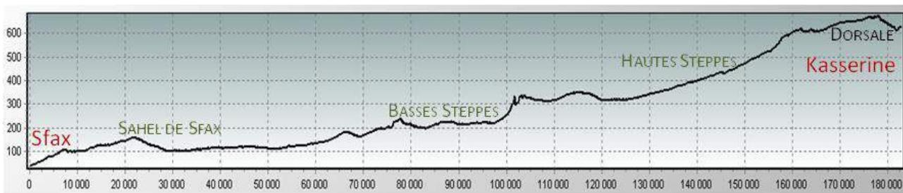
**Figure 15 : Profil en long de l'axe du terrain naturel où sera implanté la plateforme de la RN13 élargie**
